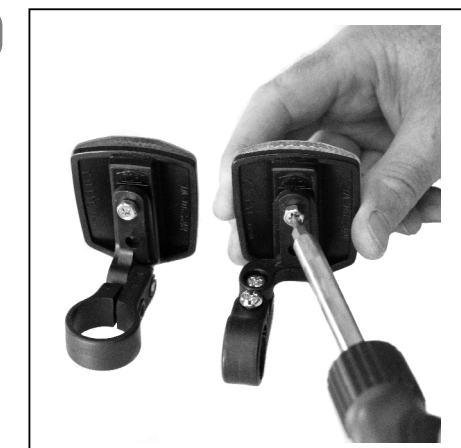
montage van de reflektoren
