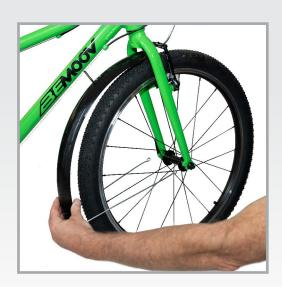
**Étape 2.** Glissez le garde boue avant, muni de son équerre noire, de l'arrière vers l'avant du vélo, sous la fourche et sous le câble de frein avant. L'équerre noire de fixation se positionnant contre le trou se trouvant à l'arrière de la fourche.
