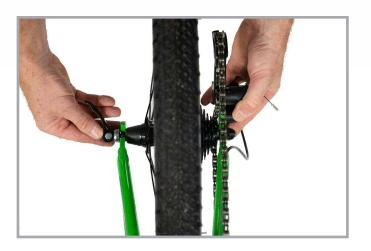
**Étape 3.** Desserrez et ouvrez le serrage rapide de la roue arrière. En repoussant légèrement vers l'arrière du vélo votre dérailleur, sortez vers le haut la roue des encoches d'emboitements du cadre.
