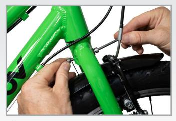
**Étape 3.** Glissez la vis A x1 dans le trou de la fourche de l'avant vers l'arrière du vélo en prenant soin de positionner la rondelle entre l'embout allen et la peinture. Fixez le garde-boue (au niveau de l'équerre), dans sa position la plus basse, en serrant l'écrou autobloquant.
