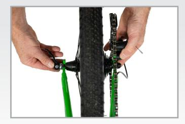
En relâchant progressivement le dérailleur, emboitez l'axe de la roue au niveau des encoches d'emboitements des pattes arrières du cadre.
