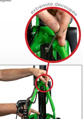
**Étape 5.** Fixez et serrez, à l'aide de deux vis C x5, la tringle noire au niveau des pas de vis se trouvant à l'extrémité des pattes arrières du cadre.
